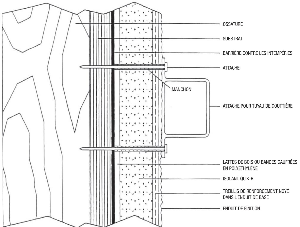
NOTE : UN SCELLANT DOIT ÊTRE APPLIQUÉ ENTRE LES ATTACHES DE LA GOUTTIÈRE ET L'ENDUIT DE FINITION
